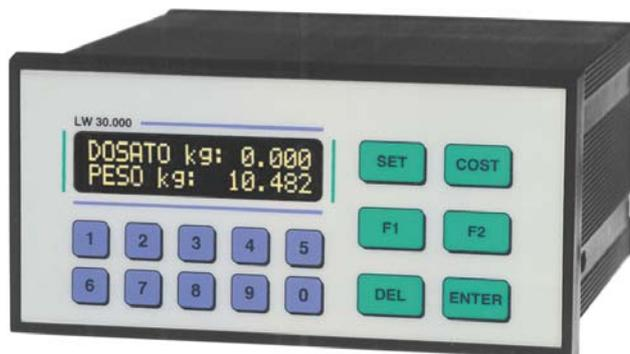
Strumento in custodia a norme DIN (72x144x170 mm, foratura 67x138mm) per montaggio fronte quadro. Display LCD alfanumerico retroilluminato, 2 righe da 16 caratteri (altezza 5 mm). Grado protezione del frontale IP 54. Fusibile di protezione accessibile dall'esterno.
